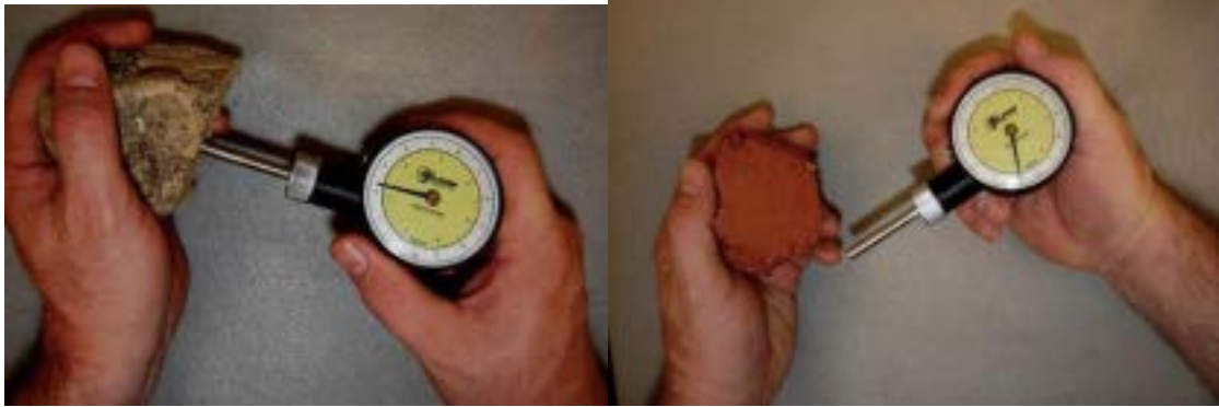
Figura 3.4.1.2. Cara plana de la muestra lista para probar. Figura 3.4.1.3. Prueba con penetrómetro.
